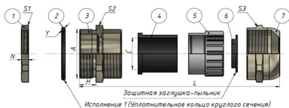
Исполнение 1 (Уплотнительное кольцо круглого сечения)
